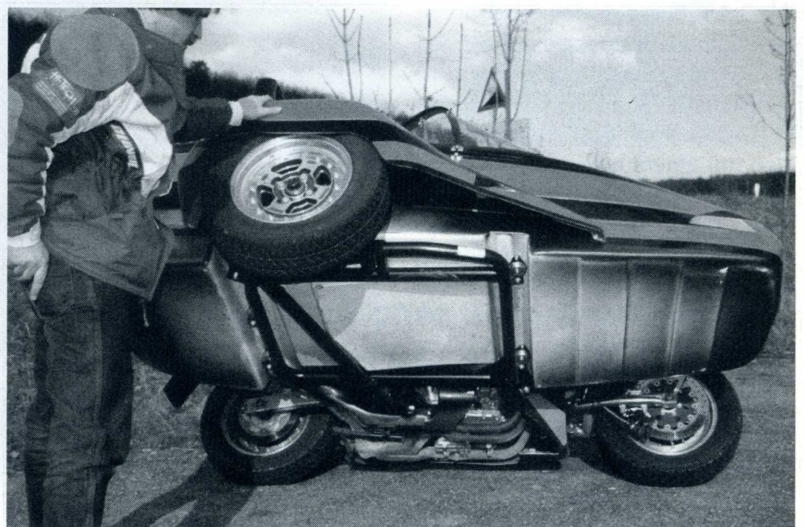
Unter dem Orion verbirgt sich eine konventionelle Rechteck-Rahmenkonstruktion mit einer gezogenen Schwinge, die von einem Fournales-Federbein gestützt wird.
