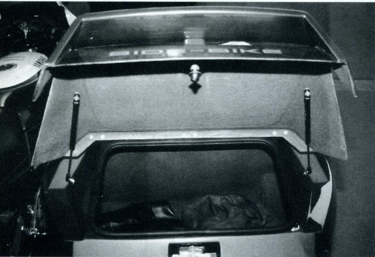
Der 330 Liter große Kofferraum des Mega-Comete wird mit einem Hebel, der sich in einem Staufach im Boot befindet, geöffnet. Der Kofferraum ist sehr tief und wegen der etwas kleineren Kofferraumöffnung nicht optimal zugänglich.
