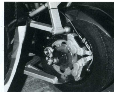
Blickwinkel für Technik-Begeisterte. Die Achschenkellentechnik des Side-Bike-Umbaus beim Mega-Comete.
