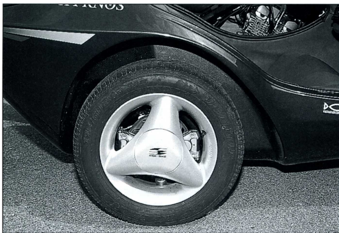
▲ Die zwei Bremszangen am SW-Rad werden einmal via Fußbremse und einmal über den Handbremshebel angesteuert.
