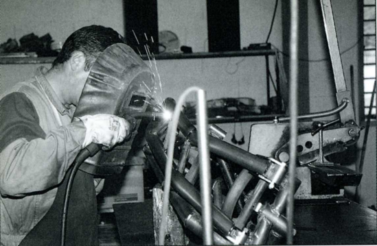
Die Rahmen werden in speziellen Vorrichtungen zusammen geschweißt.
