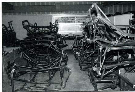
Dann werden die Rahmenteile en bloc zum Beschichten gebracht.
