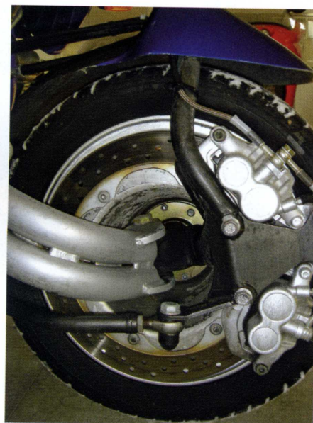
Der Achsschenkelbolzen des Vorderrades muss regelmäßig auf festen Sitz und dessen Lagerung (Nadellagerhülsen) überprüft werden. Hier besteht die Gefahr von eindringendem Wasser und nachfolgendem Rost.
