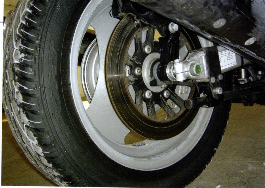
Bei der Reifenwahl hat man nicht viel Möglichkeiten. Erlaubt sind die Größen 165/60 und 165/65 R 14.
