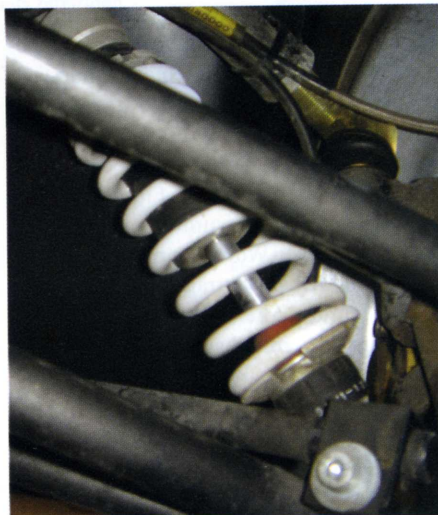
Das Seitenwagenfederbein wird durch die flache Anstellung stark belastet. Kolbenstange und deren Dichtung sind regelmäßig zu kontrollieren.
