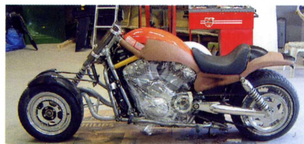
Die Front-Tank-Sitzbank-Heckkombination ist eine Einzelanfertigung. Sie verleiht der V-Rod eine neue und eigenständige Linie und ist auch für Solomaschinen zu erwerben.
