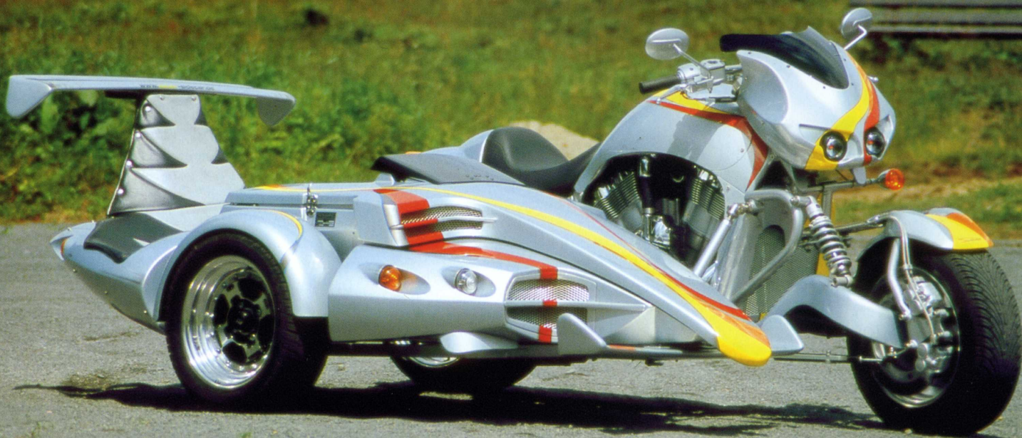
Spurbreite 1460 Millimeter. Durch das flache Boot schätzt man das Gespann schlanker ein. Aber der Hebelarm der Spurbreite sorgt auch ohne Passagier für reichlich Bodenkontakt in Rechtskurven.
