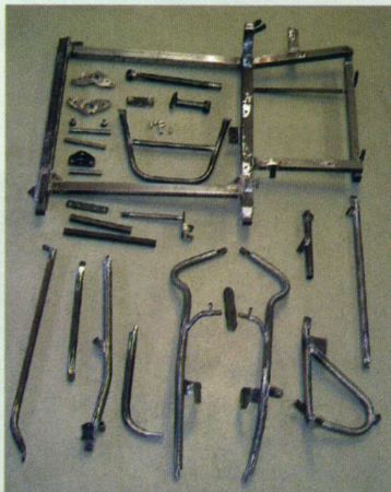
Das sind alle Stahlteile, die für den Gespannubau der Buell angefertigt werden müssen.
